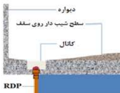
شکل ۳- دیوار و کانال روی پشت بام برای جمع آوری آب باران [۱۶]
